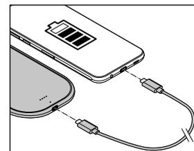
▷ Schließen Sie die Powerbank wie abgebildet mit einem USB-Kabel an das Gerät an, das Sie laden möchten. Wenn Sie ein Gerät mit USB-C-Anschluss laden möchten, verwenden Sie das beiliegende USB-C-Anschlusskabel.
